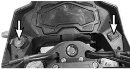
El vehículo dispone de dos entradas auxiliares donde se puede conectar el dispositivo móvil, vía USB, o equipo externo, puerto auxiliar. La capacidad máxima de la puerta auxiliar es de 20W, que no debe superarse para no comprometer el buen funcionamiento del vehículo.
