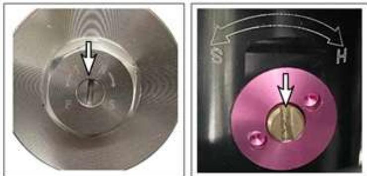
Es posible ajustar el rebote (o extensión) del amortiguador con la ayuda de un destornillador girando la ranura de ajuste en el sentido de las agujas del reloj para aumentar la resistencia o en el sentido contrario a las agujas del reloj para reducir. Siempre debes ajustar los amortiguadores delanteros juntos y nunca solo uno.
