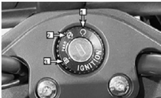
La cerradura de encendido controla el sistema de encendido y el sistema de iluminación y tiene las siguientes características:
