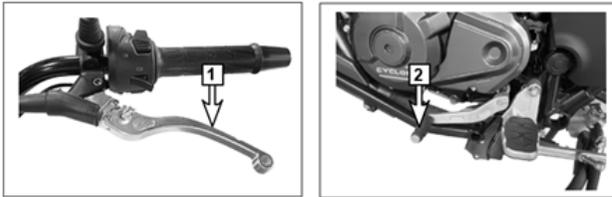
5. Después de que el vehículo se haya calentado, retire el caballete lateral y apriete la palanca del embrague (1);
