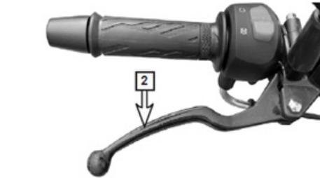
2 - Sujete la palanca del freno delantero o presione el pedal del freno trasero, sostenga completamente la palanca del embrague o deje el motor en la marcha N y presione el interruptor de corte de corriente
