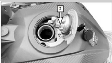
2 - Alinee la tapa de llenado de combustible con la ranura de llenado de combustible y presione suavemente la tapa de llenado de combustible hacia abajo.
