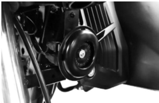
Después de que la motocicleta haya estado funcionando por un tiempo, la contratuerca y el tornillo de ajuste de la bocina eléctrica pueden aflojarse, lo que resulta en ronquera o silencio de la bocina eléctrica. La bocina eléctrica debe ajustarse en el centro de servicio de mantenimiento especial del concesionario.
