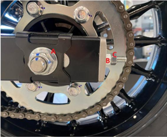
1. Desatornille la tuerca del eje de la rueda (A);
