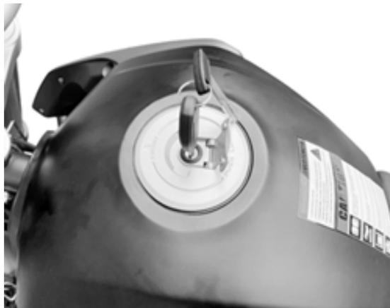
El depósito de combustible se encuentra entre el manillar y el asiento. Para exponer la ranura de la cerradura y abrir la tapa de combustible, abra la tapa de protección. Luego inserte la llave en la ranura y gírela en el sentido de las agujas del reloj. La tapa se abrirá y podrá llenar.
