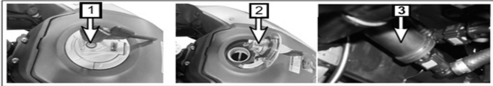
El depósito de combustible se encuentra entre el manillar y el asiento. Para abrir la tapa de combustible, abra la tapa de protección. Luego inserte la llave en la ranura y gírela en el sentido de las agujas del reloj. La tapa se abrirá y podrá llenar.
