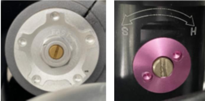
Es posible ajustar la extensión, o rebote, del amortiguador con la ayuda de un destornillador girando la ranura de ajuste en el sentido de las agujas del reloj para aumentar la resistencia o en el sentido contrario a las agujas del reloj para reducir. Siempre debes ajustar los amortiguadores delanteros juntos y nunca solo uno.
