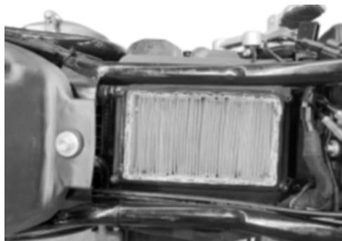
El filtro de aire debe cambiarse regularmente de acuerdo con el plan de mantenimiento (consulte la página 38 Tabla de mantenimiento). Debe cambiarse con más frecuencia si circula regularmente en ambientes húmedos o polvorientos.
