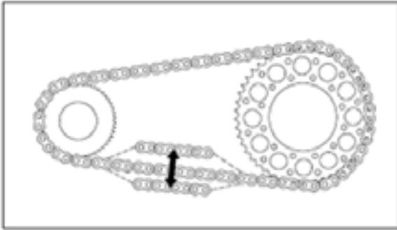
**Lubricación:** La lubricación de la cadena de transmisión es esencial después de conducir bajo la lluvia, en carreteras mojadas, después de lavar el vehículo o siempre que parezca estar seco:- Limpiar la cadena, la cremallera y el piñón con un limpiador de cadenas adecuado aconsejado por el fabricante;- utilizar un cepillo suave si están especialmente sucios;
