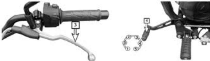
3. La palanca del embrague se encuentra en el lado izquierdo del manillar. Al presionarlo hacia el manillar, se rompe la conexión entre el motor y las ruedas.
