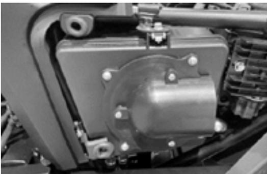
El filtro de aire debe cambiarse regularmente de acuerdo con el plan de mantenimiento (consulte la página 30 Tabla de mantenimiento). Debe cambiarse con más frecuencia si circula regularmente en ambientes húmedos o polvorientos.
