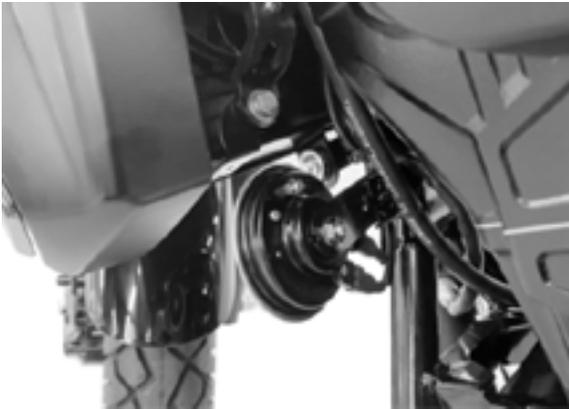
Después de que la motocicleta haya estado funcionando por un tiempo, la contratuerca y el tornillo de ajuste de la bocina eléctrica pueden aflojarse, lo que resulta en ronquera o silencio de la bocina eléctrica. La bocina eléctrica debe ajustarse en el centro de servicio de mantenimiento especial del concesionario.
