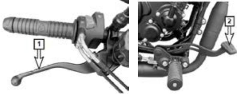
1. La palanca del freno delantero controla la velocidad de desplazamiento de la rueda delantera. Para frenarlo debes presionarlo hacia el manillar y queda en el lado derecho.
