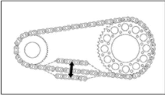
**Lubricación:** La lubricación de la cadena de transmisión es esencial después de conducir bajo la lluvia, en carreteras mojadas, después de lavar el vehículo o cuando parezca estar seco:- Limpie la cadena, la corona y el piñón con un limpiador de cadenas adecuado recomendado por el fabricante;- use un cepillo suave si están especialmente sucios;
