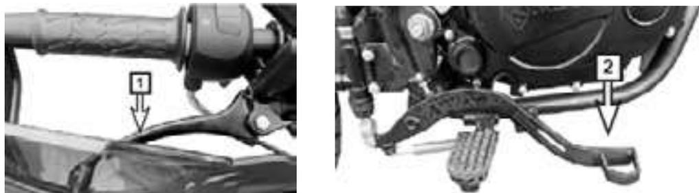
1. La palanca del freno delantero controla la velocidad de desplazamiento de la rueda delantera. Para frenarlo debes presionarlo hacia el manillar y queda en el lado derecho.
