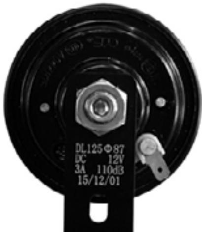
Después de que la motocicleta haya estado funcionando durante un tiempo, la contratuerca y el tornillo de ajuste de la bocina eléctrica pueden aflojarse, lo que provoca ronquera o silencio de la bocina eléctrica. La bocina eléctrica debe ajustarse en el centro de servicio de mantenimiento especial del distribuidor.
