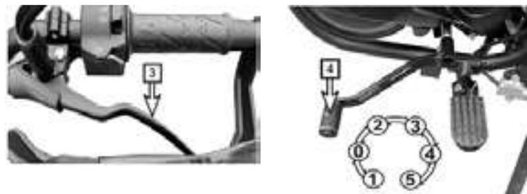
3. La palanca del embrague se encuentra en el lado izquierdo del manillar. Al presionarlo hacia el manillar, se rompe la conexión entre el motor y las ruedas.
