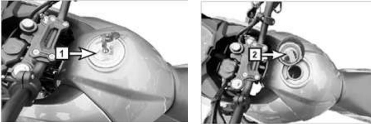
El depósito de combustible se encuentra entre el manillar y el asiento. Para exponer la ranura del tapón y abrir la tapa de combustible, abra la tapa de protección. Luego inserte la llave en la ranura (1) y gírela en el sentido de las agujas del reloj. La tapa se abrirá (2) y podrá repostar.
