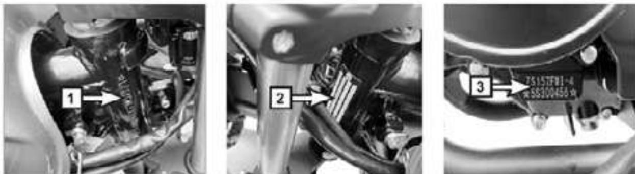
1. **VIN:** El número de identificación del vehículo, o VIN, se puede encontrar grabado en la parte delantera del vehículo junto a la columna de dirección;
